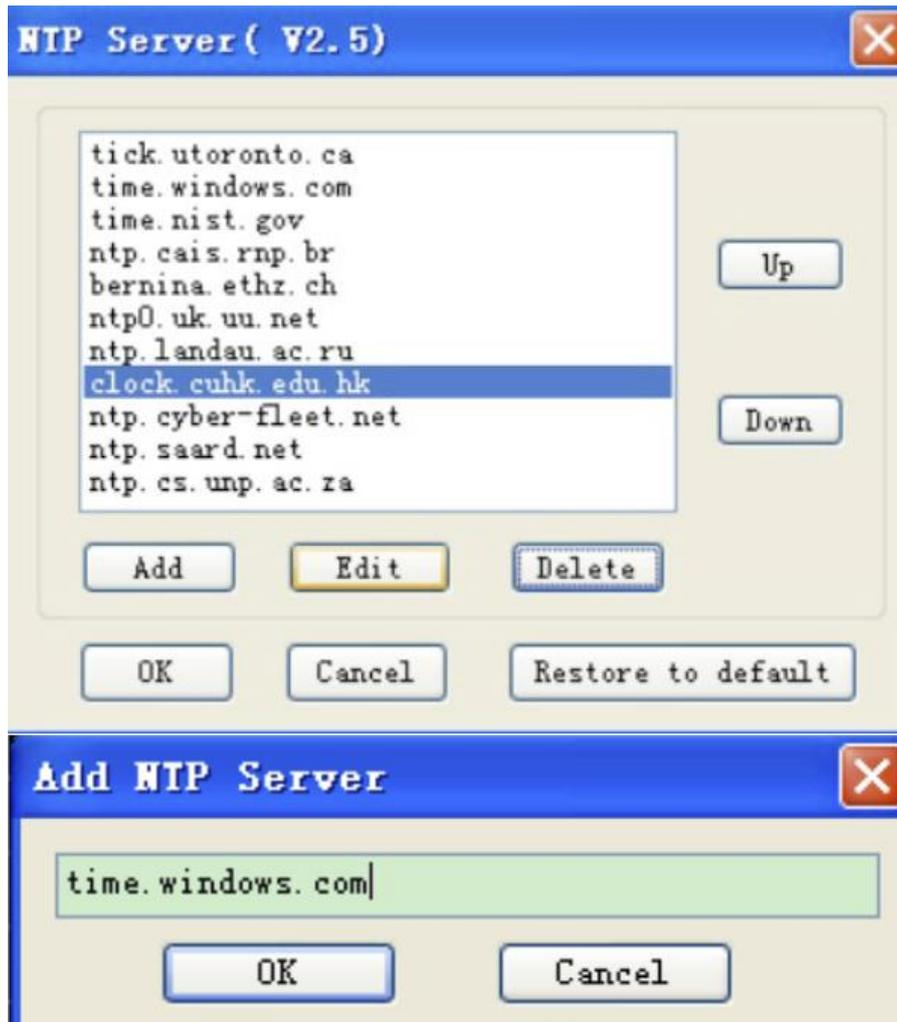
6. En caso de que alguna dirección del servidor NTP deba ser borrada, pulse Delete, y seleccione la dirección que debe ser borrada, luego pulse OK.
