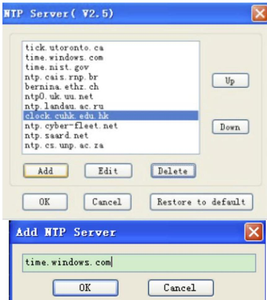
5. En caso de error en su nueva adición de la dirección del server NTP vuelva a intentarlo. Pulse Edit, cuando modifique la dirección , y pulse OK cuando finalice.
